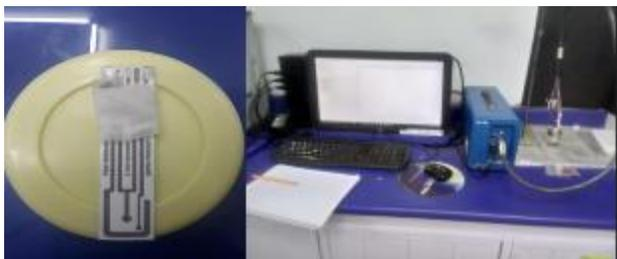
**Figura 1** Celda de Pt impresa y Potenciostato/Galvanostato
