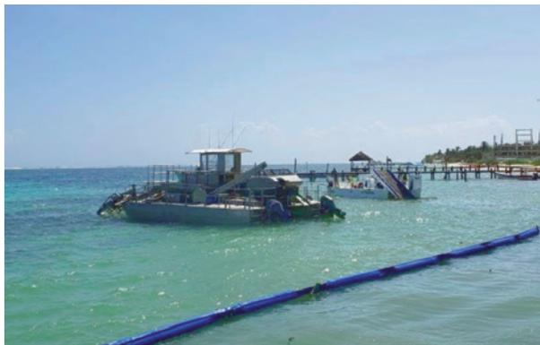
**Figura 4.** Barrera de contención de sargazo y embarcaciones sargaceras utilizadas en el Caribe mexicano. Foto: Miguel A. Diego.
