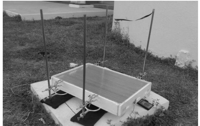
**Figura 2. Modelo de calentador de aire por convección natural.**
