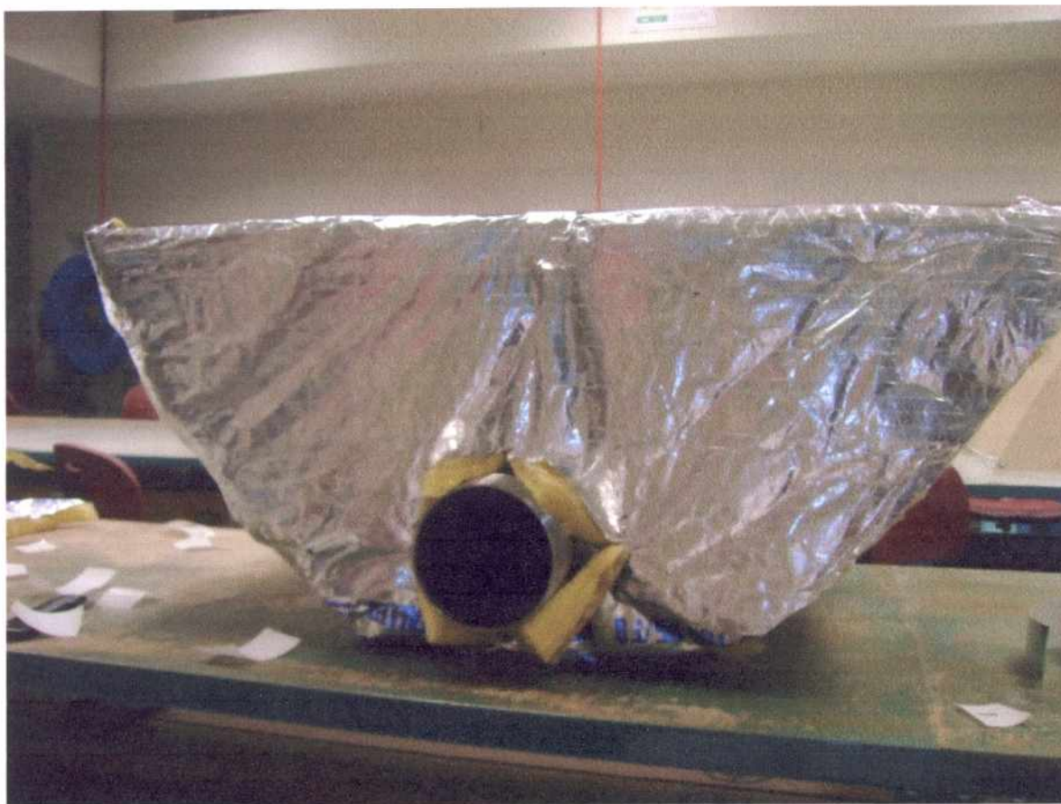
Foto 2. Colocación del aislante a KIN-PIB-1
