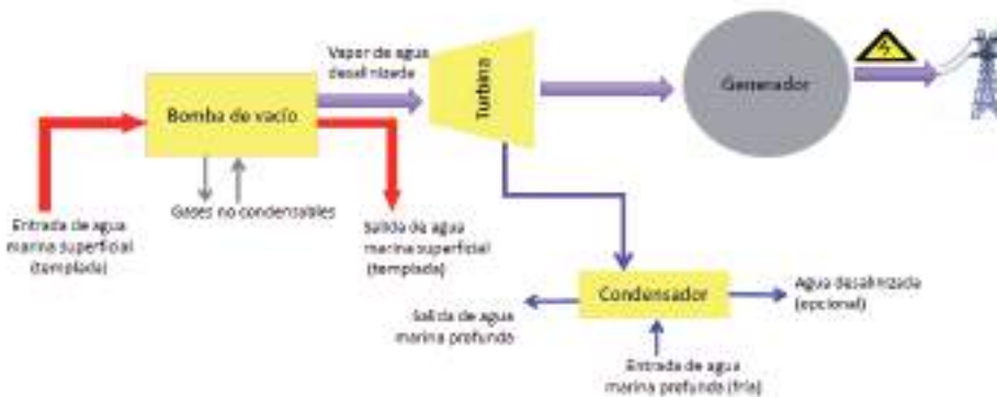
Figura 4. Esquema conceptual de una planta OTEC de ciclo abierto. Fuente: elaboración propia.
