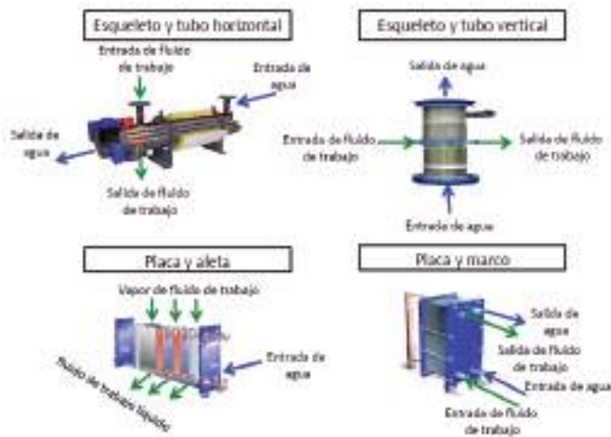
Figura 11. Diversos diseños de intercambiadores.
