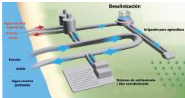
Figura 9. Esquema conceptual de una planta OTEC On-shore. Fuente: Adaptada de Ocean Thermal Energy Corporation. (2017).
