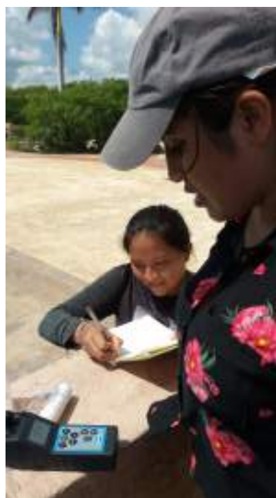
Foto 4. Los beneficiarios realizan la primera práctica de monitoreo en Malecón Tajamar, municipio de Benito Juárez y área colindante con el APFF Manglares de Nichupté. Como parte de este monitoreo se desplegó un CTD (izquierda) y se recopiló información sobre parámetros físico-químicos por medio de un Instrumento Multiparamétrico (derecha), a todo lo largo del malecón.
