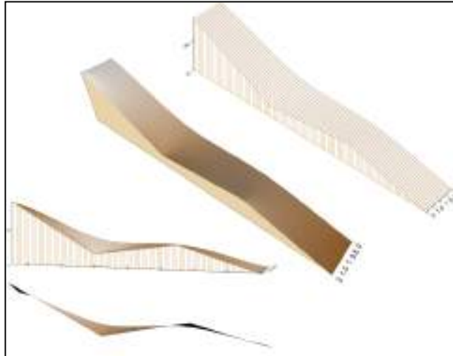
Figura 2. Modelo de un transecto de duna de Playa Delfines (Mirador) correspondiente a la temporada de verano. Los valores fueron registrados a las 8am del día 17 de septiembre de 2019 utilizando el método tradicional de levantamiento topográfico. Datos procesados con el programa Surfer®.
